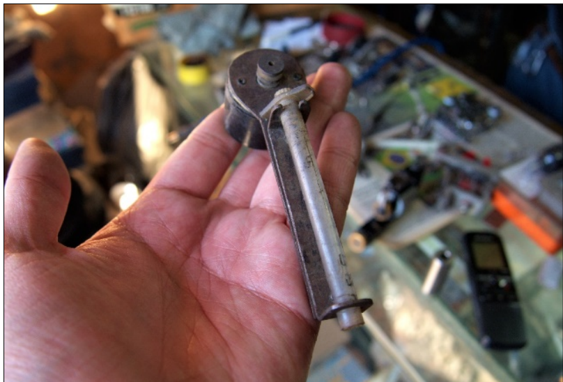
Máquina "hechiza" realizada con una jeringa y una base de metal fabricada para fungir como soporte / Fuente: Recinas, 2020
