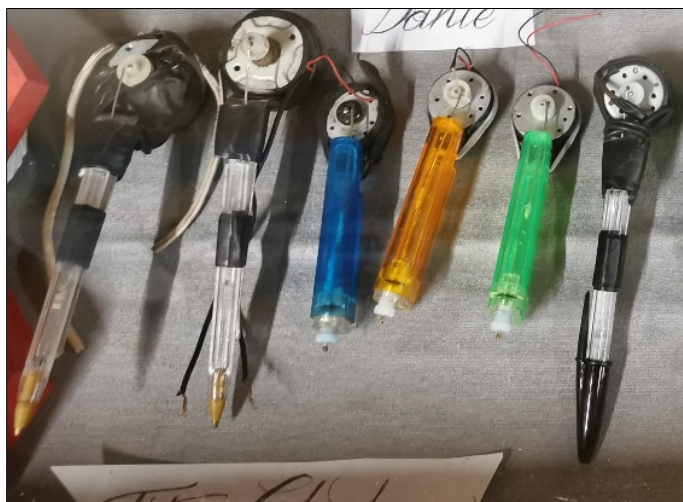
Algunos ejemplos de máquinas caseras o “hechizas” realizadas con pequeños motores ajustados a la base de bolígrafos y encendedores / Fuente: Recinas, 2019
